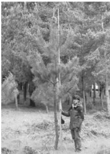
Abbildung 21: Vermessung der Baumhöhe mithilfe eines Fluchtstabes
